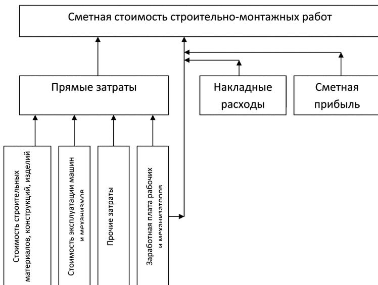
**Рис. 1. Структура затрат, определяющих сметную стоимость строительно-монтажных работ**
