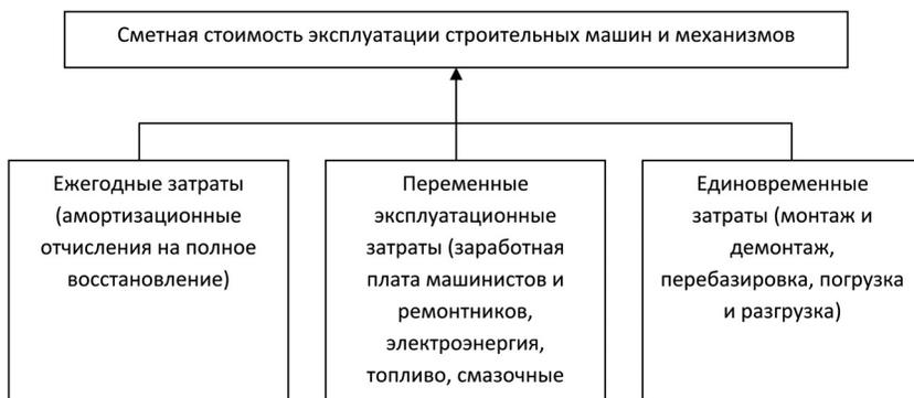
Рис. 3. Структура затрат, определяющих сметную стоимость эксплуатации строительных машин и механизмов
