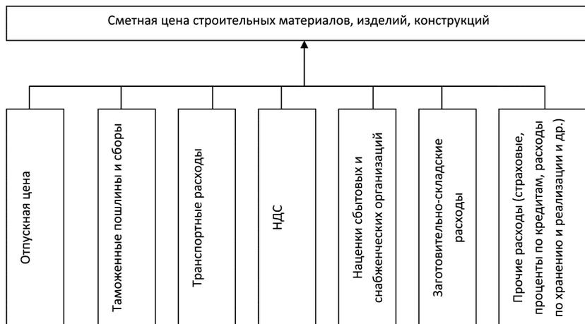
Рис. 2. Структура затрат, определяющих сметную стоимость строительных материалов
